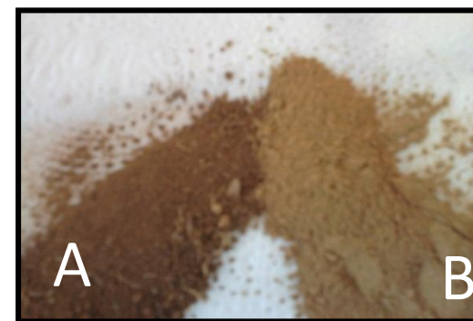
Aspecto do material antes da moagem (A) e depois da moagem (B).
