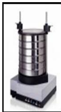
Peneiradora vibratória (Bertel) 600 \mu m
